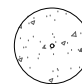
ESQUEMA FUNDAÇÕES MICRO ESTACAS Ø30CM ARMADAS AS MEDIDAS ENTRE EIXOS DEVERÃO SER CONFERIDAS DE ACORDO COM O FABRICANTE
