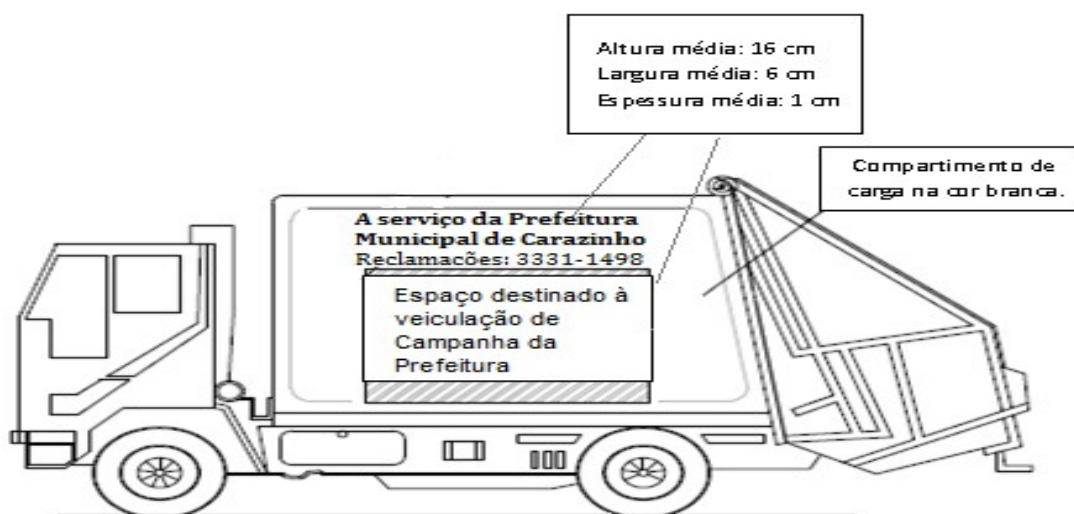
Figura 01: Padrão de cores e textos para os equipamentos.
